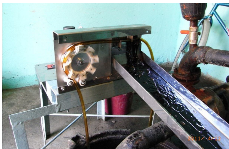
Пример монтажа скиммера 1UV с маслоприемной емкостью
